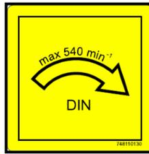
Drehrichtung der Gelenkwelle nach DIN (max. 540 min<sup>-1</sup> - DIN)
