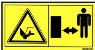
Bei laufendem Motor mit angeschlossener Zapfwelle ausreichend Abstand vom Bereich der Mähmesser halten.
