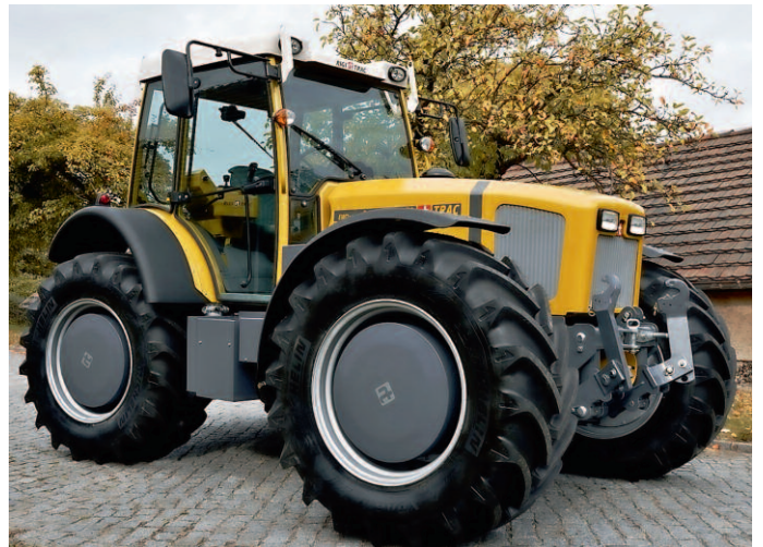
Die Abdeckungen auf den Radnaben schützen die Elektromotoren vor Verschmutzung.
