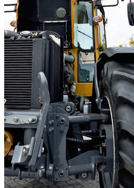
Die Räder haben eine Einzelradaufhängung. Da durch Radnabenantrieb keine Antriebswelle notwendig ist, entstehen Konstruktionsfreiheiten.
